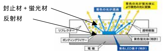
図 2 LEDパッケージの断面
