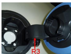
図 5 . ヒンジ樹脂化によるR付け
