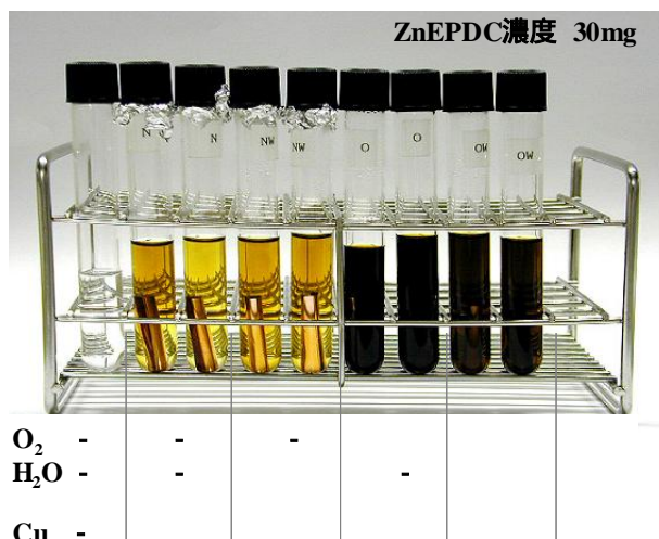
図 9 . 酸素、水有無の銅溶出試験後の媒体
