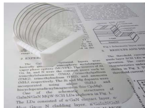
図-11 大型高温高圧炉で多数枚同時成長した結晶に対して、研磨・ベベリングから洗浄までを社内の開発工程で実施し、作製されたGeドープ2インチNFx-GaN自立基板
