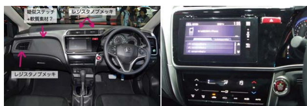
図-16 スポーティグレード（ホンダCity） インパネ全体（左図）、タッチパネル（右図）
