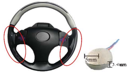
図-6 ステアリングホイール振動箇所とコイン型振動モーター
