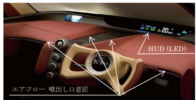
図-3 省エネLED表示とエアフロー構造
