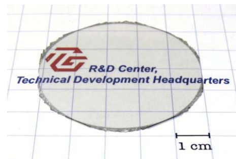
図-10 小型高温高圧炉で成長された厚さ0.35 mmのノンドープ2インチNFx-GaN結晶（研磨後）
