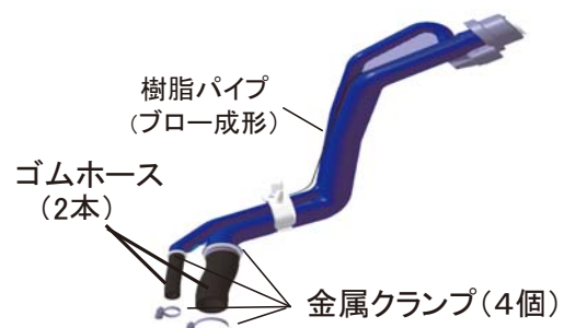
図-2 ブロー成形品の構造例
