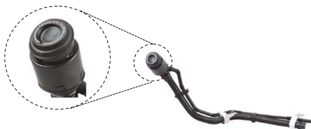
図-12 キャップレス式フューエルフィラパイプ
