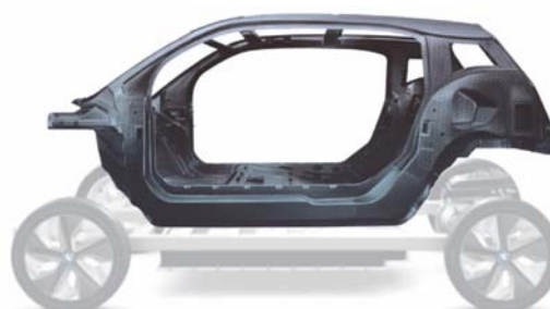
図-5 BMW i3 CFRP モノコック
