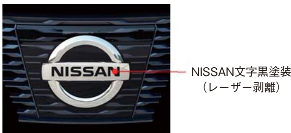
図-4 レーザー剥離部
