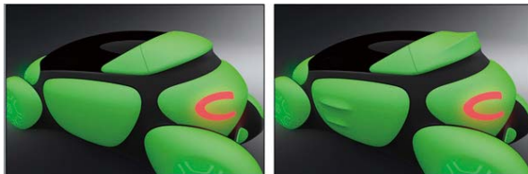
図-5 e-Rubber モーフィング例
