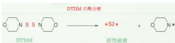
図-8 有機加硫剤 DTDM の硫黄放出機構
