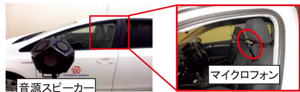
図-7 車内音計測方法
