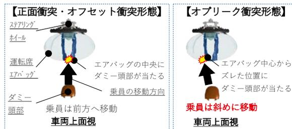
図-2 衝突試験時の車室内の様子
