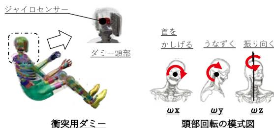
BrICとは、脳の傷害値<sup>\*2</sup>で、ジャイロセンサーで、ダミーの頭部にかかる回転（角速度 $\omega_x, \omega_y, \omega_z$ ）を計測し算出。
